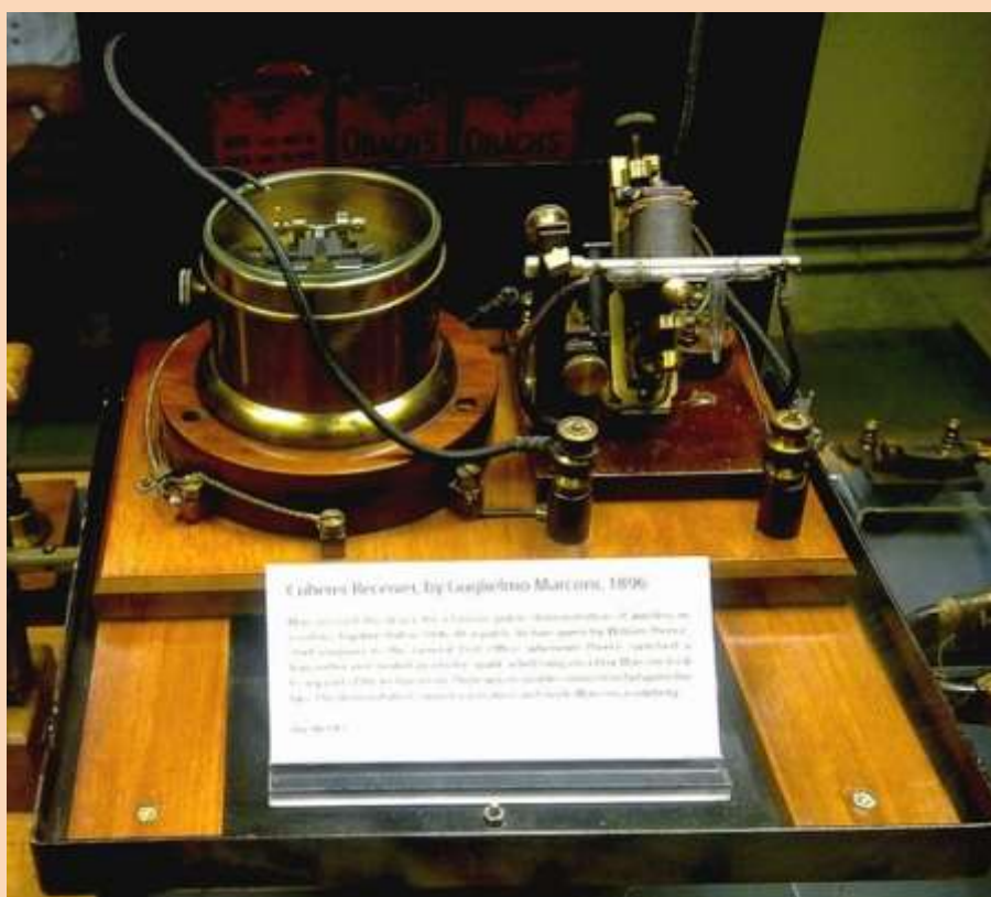
Un des premiers récepteurs cohéreurs de Marconi (1896) CC BY-SA 3.0
